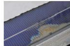
背板失效引起的電池腐蝕
